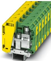
接地端子，连接量: 2，位数: 1，接线方式: 螺钉连接，额定接线容量: 70 mm<sup>2</sup>，横截面: 16 mm<sup>2</sup> - 95 mm<sup>2</sup>，安装方式: PE支脚及安装螺钉，M6，安装方式: NS 35/7,5，NS 35/15，NS 35/15-2,3，NS 32，颜色: 黄绿相间
