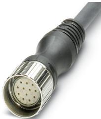
主电缆，应用：传感器/执行器分线盒，位数：12，插槽类型：单通道，状态显示：否；主电缆连接：M23针式插头连接，PUR/PVC，电缆长度：5 m，屏蔽：无，备选产品符合RoHS II非豁免 6c (Pb < 0.1 %) 产品编号：1260770
