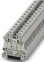
直通式接线端子，带梅花头螺钉，标称工作电压: 1000 V，额定电流: 57 A，连接量: 2，接线方式: 螺钉连接，额定接线容量: 10 mm<sup>2</sup>，横截面: 0.5 mm<sup>2</sup> - 16 mm<sup>2</sup>，安装方式: NS 35/7.5, NS 35/15，颜色: 灰色
