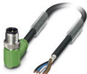
センサ/アクチュエータケーブル, 5-極, PUR ハロゲンフリー, 黒-灰RAL 7021, シールド対応, プラグ アングル M12, Aコーディング, 上 片側フリー, ケーブル長: 10 m
