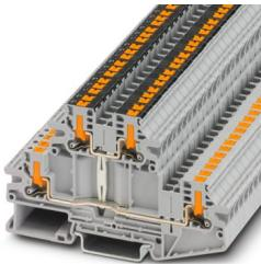
双层接线端子，标称工作电压: 800 V，额定电流: 22 A，接线方式: 直插式连接，第一和第二层，额定接线容量: 2.5 mm<sup>2</sup>，横截面: 0.14 mm<sup>2</sup> - 4 mm<sup>2</sup>，安装方式: NS 35/7,5，NS 35/15，颜色: 灰色
