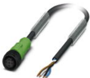
センサ/アクチュエータケーブル, 4-極, PUR ハロゲンフリー, 黒-灰RAL 7021, 片側フリー, 上 ソケット ストレート M12, Aコーディング, ケーブル長: 5 m, プラスチック製ローレット付き
