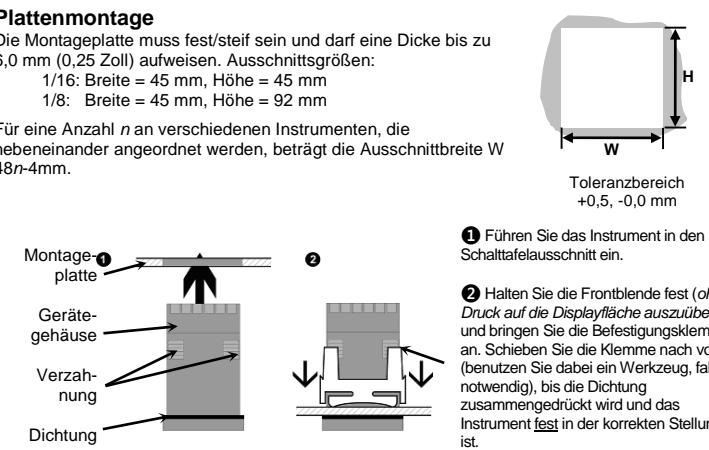
**ACHTUNG:** Um eine effektive Dichtung nach IP65 und Schutz gegen Staub und Feuchtigkeit zu gewährleisten, sollten Sie sichergehen, dass die Dichtung eng gegen die Platte gedrückt wird und sich die 4 Zapfen im selben Ratschenschlitz befinden.
