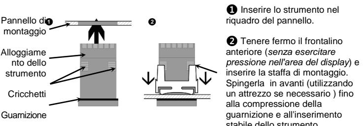
**ATTENZIONE:** per una tenuta ottimale della guarnizione IP65 contro polvere e umidità verificare che la guarnizione sia fissata in modo uniforme sul pannello, con le 4 lingue nella stessa scanalatura della staffa
