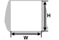
Pour  $n$  instruments montés côte à côte, la largeur de découpe W est  $48n-4\text{mm}$ .
