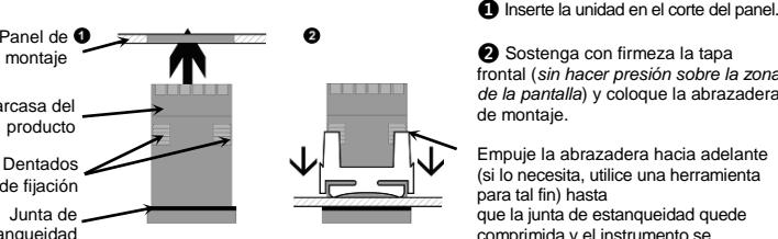
**PRECAUCIÓN:** Para conseguir un sellado IP65 efectivo contra el polvo y la humedad, asegúrese de que la junta de estanqueidad quede bien comprimida contra el panel con las 4 lengüetas colocadas en la misma ranura del dentado de fijación.
