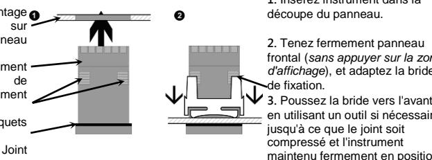
**ATTENTION :** Pour une étanchéité IP65 assurez-vous que le joint soit bien comprimé contre le panneau, avec les quatre languettes situées dans le même intervalle de cliquet.
