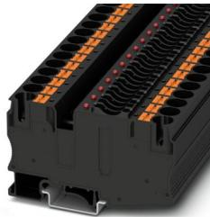
保险丝接线端子，保险丝类型: 扁形，保险丝类型: C，标称工作电压: 12 V，额定电流: 25 A，接线方式: 直插式连接，额定接线容量: 10 mm<sup>2</sup>，接线容量: 0.5 mm<sup>2</sup>- 16 mm<sup>2</sup>，安装方式: NS 35/7,5，NS 35/15，颜色: 黑色
