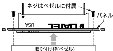
bezelsの取り付け法(図12)
