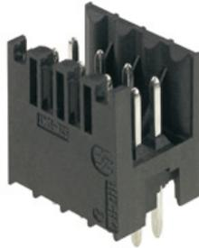
Hochtemperaturfeste, zweireihige Stiftleiste für alle gängigen Lötverfahren. Optimiert für die Automatenbestückung. Verpackung in Box oder Tape. Stiftlänge 3,2 mm für Reflow- und Wellenlötanwendungen geeignet. Die Stiftleisten bieten Platz für Beschriftungen und können kodiert werden. (Tapeverpackung auf Anfrage)
