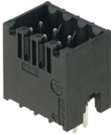
Hochtemperaturfeste, zweireihige Stiftleiste für alle gängigen Lötverfahren. Optimiert für die Automatenbestückung. Verpackung in Box oder Tape. Stiftlänge 3,2 mm für Reflow- und Wellenlötanwendungen geeignet. Die Stiftleisten bieten Platz für Beschriftungen und können kodiert werden.
