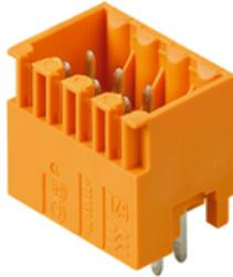
Gerade, zweireihige Stiftleiste in den Ausführungen seitlich geschlossen oder mit Flansch (seitlich offene Stiftleisten auf Anfrage). Die Stiftleisten mit der Stiftlänge 3,5 mm sind für das Wellenlöten ausgelegt und in einer Box-Verpackung. Ein Verschrauben mit der Leiterplatte ist möglich. Die Stiftleisten bieten Platz für Beschriftung und können kodiert werden.
