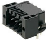
Hochtemperaturfeste, zweireihige Stiftleiste für alle gängigen Lötverfahren. Optimiert für die Automatenbestückung. Verpackung in Box oder Tape. Stiftlänge 3,2 mm für Reflow- und Wellenlötanwendungen geeignet. Die Stiftleisten bieten Platz für Beschriftungen und können kodiert werden.
