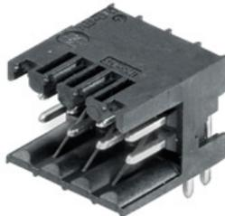
Hochtemperaturfeste, zweireihige Stiftleiste für alle gängigen Lötverfahren. Optimiert für die Automatenbestückung. Verpackung in Box oder Tape. Stiftlänge 3,2 mm für Reflow- und Wellenlötanwendungen geeignet. Die Stiftleisten bieten Platz für Beschriftungen und können kodiert werden.
