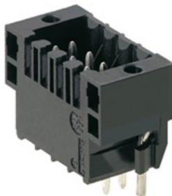
Hochtemperaturfeste, zweireihige Stiftleiste für alle gängigen Lötverfahren. Optimiert für die Automatenbestückung. Verpackung in Box oder Tape. Stiftlänge 3,2 mm für Reflow- und Wellenlötanwendungen geeignet. Die Stiftleisten bieten Platz für Beschriftungen und können kodiert werden.
