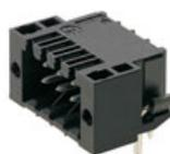
Hochtemperaturfeste, zweireihige Stiftleiste für alle gängigen Lötverfahren. Optimiert für die Automatenbestückung. Verpackung in Box oder Tape. Stiftlänge 3,2 mm für Reflow- und Wellenlötanwendungen geeignet. Die Stiftleisten bieten Platz für Beschriftungen und können kodiert werden.
