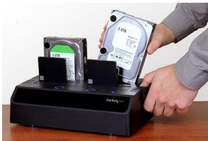
Cette station d'accueil, qui prend en charge des disques SATA I, II et III ainsi que des lecteurs à grande capacité (testé jusqu'à 6 To), est compatible avec la quasi-totalité des disques SSD ou HDD SATA de 2,5 po et 3,5 po.
