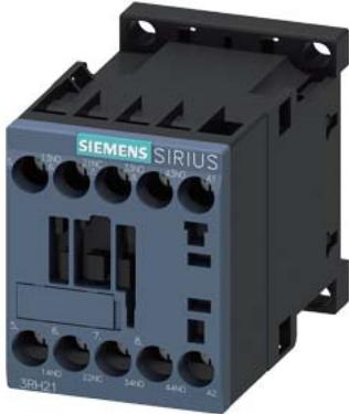
Hilfsschütz, 3 S + 1 Ö, AC 24 V, 50/60 Hz, Schraubanschluss, Baugröße S00
