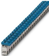
接线端子，标称工作电压: 300 V，额定电流: 125 A，接线方式: 螺钉连接，额定接线容量: 35 mm<sup>2</sup>，横截面: 2.5 mm<sup>2</sup> - 35 mm<sup>2</sup>，安装: 中性汇流条，颜色: 蓝色
