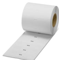
Kabelwickeletikett, Rolle, weiß, unbeschriftet, beschriftbar mit: THERMOMARK E.300 (D)/600 (D), THERMOMARK ROLL 2.0, THERMOMARK ROLL, THERMOMARK ROLL X1, THERMOMARK ROLMASTER 300/600, THERMOMARK X1.2, Kabeldurchmesserbereich: 3,2 ... 5,1 mm, Montageart: kleben, Kabeldurchmesser: ≤ 5,1 mm, Anzahl der Einzelschilder: 10000, Textfeldhöhe: 9,5 mm, Textfeldbreite: 25,4 mm
