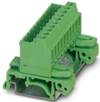
DIN导轨连接器，额定横截面: 2.5 mm<sup>2</sup>，颜色: 绿色，额定电流: 12 A，额定电压(III/2): 320 V，触点表面: Sn，触点类型: 针式插头，电位数: 7，行数: 1，位数: 7，连接量: 7，产品系列: UMSTBVK 2,5/..-G，针距: 5.08 mm，接线方式: 带压片的螺钉连接，螺钉头规格: L 开槽，导线/PCB连接方向: 0 °，每个电势的焊针数量: 1，插拔系统: COMBICON MSTB 2,5，互锁: 不带，安装方式: 不带，包装类型: 纸箱包装
