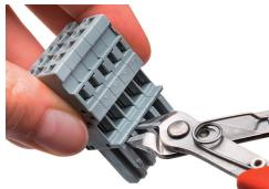
Codage d'un connecteur femelle – Enlever la(s) tige(s) de codage à l'aide d'un outil coupant Ni la 1ère ni la dernière tige de codage, elles servent à la fixation.
