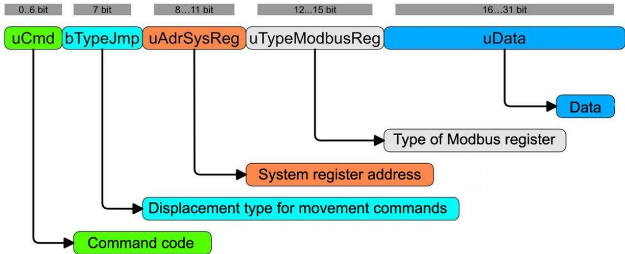
Fig. 9. Estructura de una instrucción de programa de usuario
