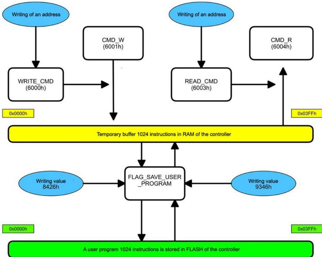
*Fig.8. Diagrama de flujo de los procedimientos para leer y escribir un programa de usuario*
