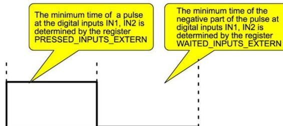
Fig.5. Supresión del rebote de contacto
