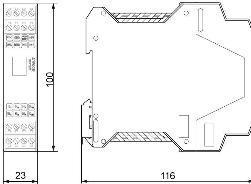
Fig. 1. Dimensiones generales y de conexión del controlador RS 206417
