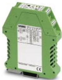
Convertidor de corriente MCR, programable y configurable, para la medición de corrientes continuas, alternas y distorsionadas, con salida de relé y salida de transistor, corriente de entrada desde 0 ... 0,2 A hasta 0 ... 11 A, sin configurar
