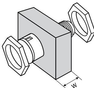
w = max. installation wall thickness / max. Einbauwandstärke
