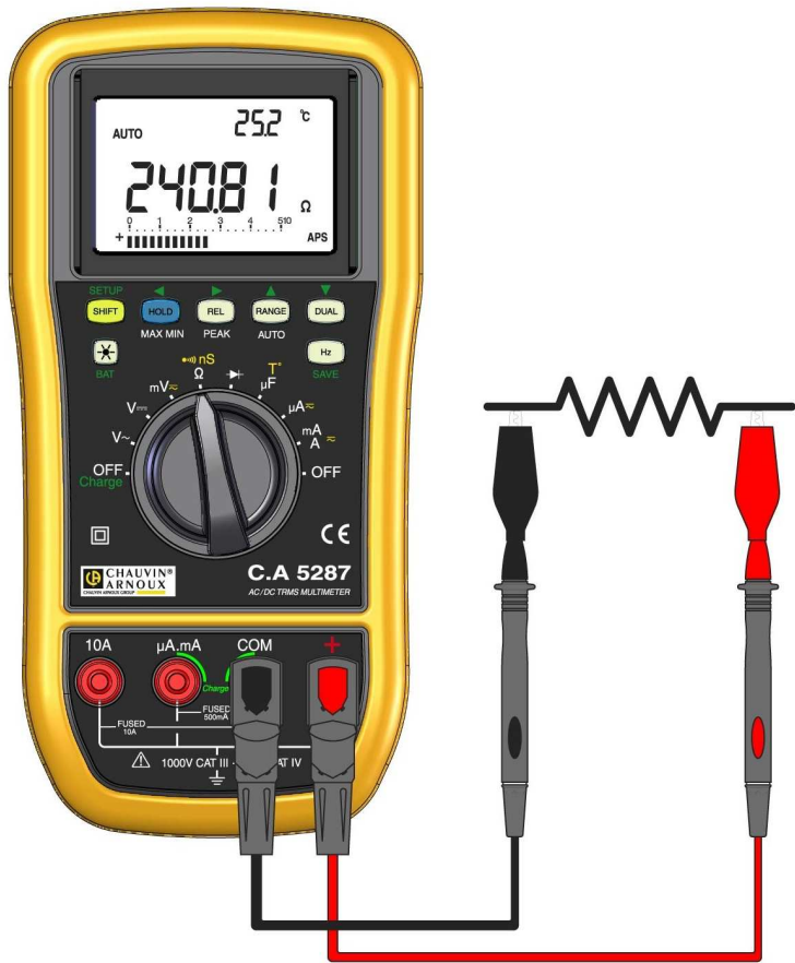
Figure 45 – Mesure de résistance
