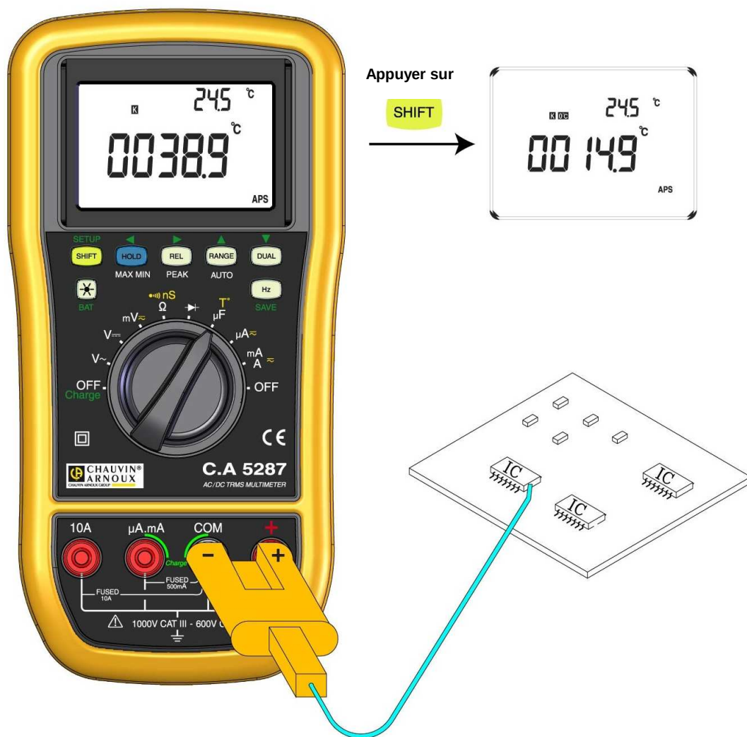
Figure 50 – Mesure de la température de surface
