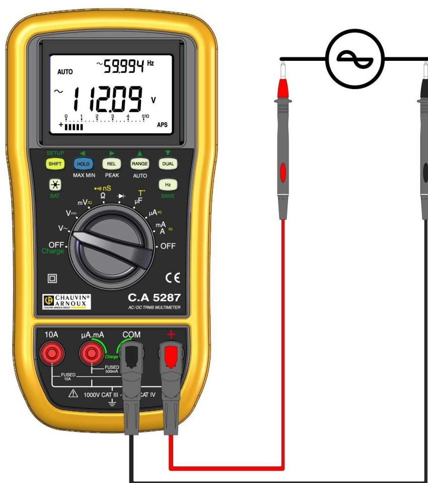
Figure 38 – Mesure de la tension du réseau
