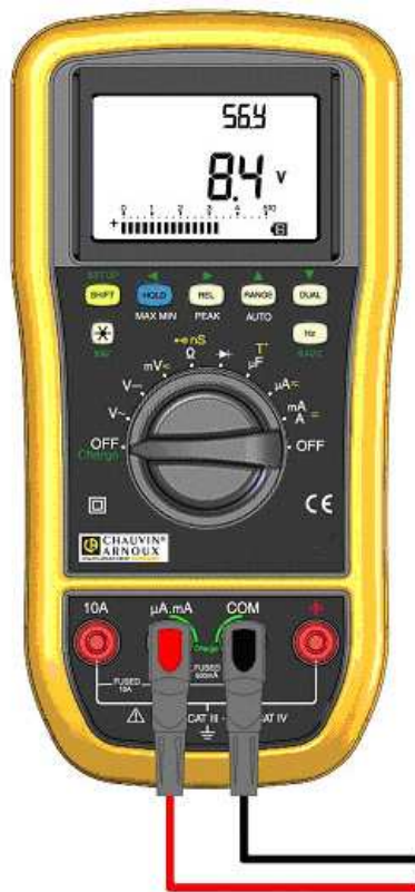
Figure 51 – Recharge de la batterie
