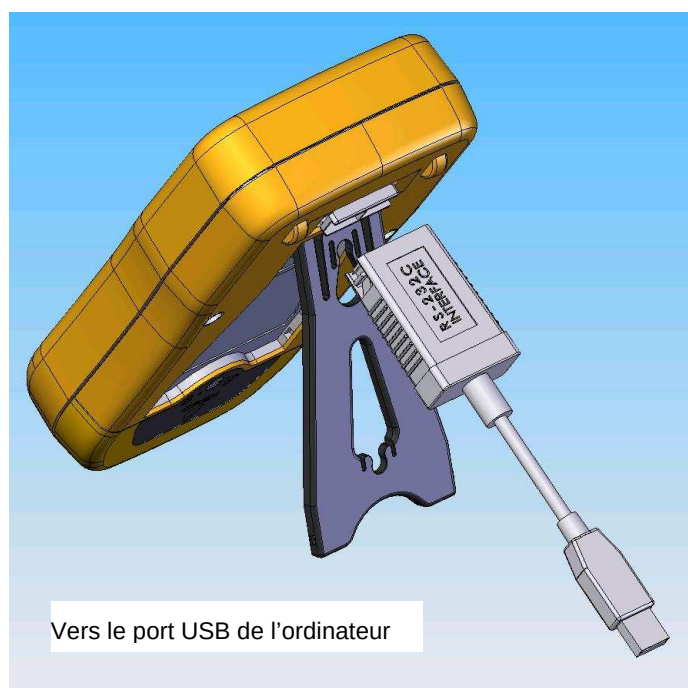
Figure 33 – Connexion du câble de communication
