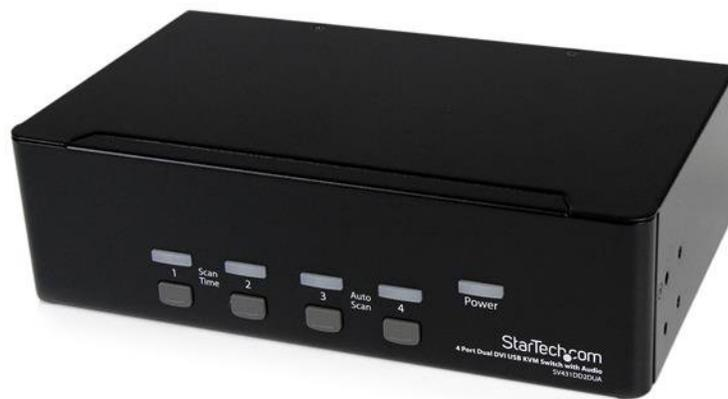
Le commutateur KVM USB double DVI à 4 ports SV431DD2DUA permet le partage entre quatre PC dotés de sorties vidéo double DVI, et deux moniteurs, un microphone et un ensemble de haut-parleurs, un clavier et une souris ainsi que deux autres périphériques USB.
