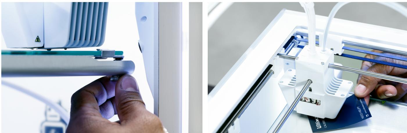
Dopo la calibrazione del piano di stampa con il primo ugello, è necessario procedere all'allineamento anche del secondo ugello per garantire che le altezze di entrambi gli ugelli siano correttamente impostate. Per questo secondo ugello occorre soltanto impostare l'altezza corretta utilizzando il cartoncino di calibrazione.
