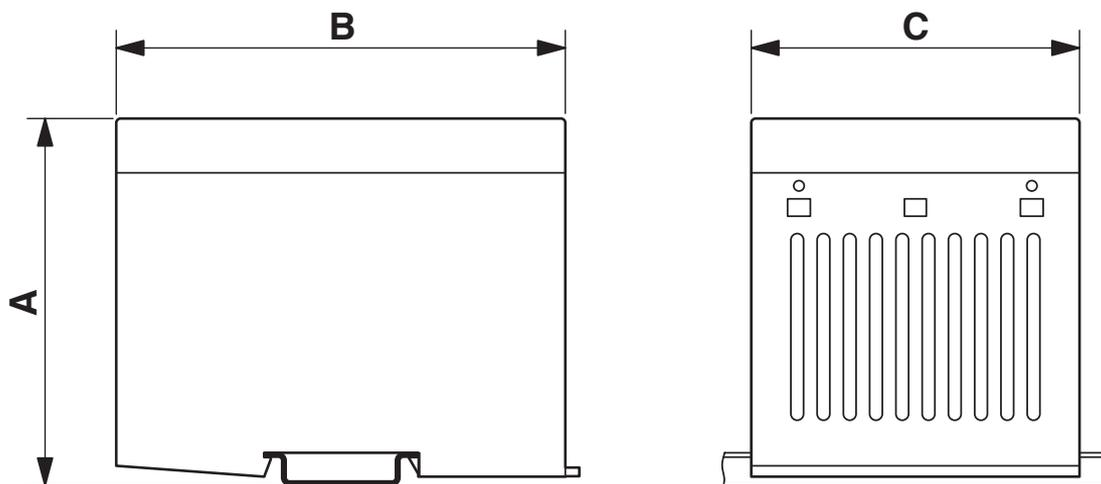
尺寸 A: 133 mm ; 尺寸 B: 102 mm ; 尺寸 C: 50 mm
