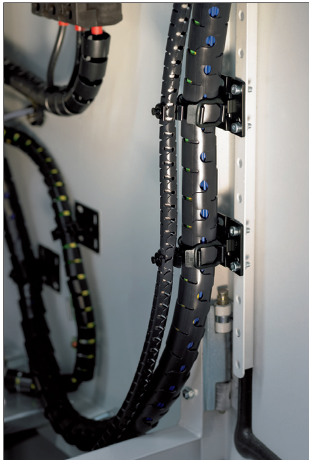
HWPAV0 is zeer geschikt bij schurende werking en als brandbescherming.
