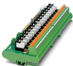
16-kanaliges Relaismodul für Honeywell C300 Eingabe-Baugruppen. Das Modul wird steuerungsseitig über D-SUB 37-polig oder FLK 50-polig angesteuert. Feldseitig steht ein Schraubanschluss mit Messertrennung zur Verfügung. Modulbreite: 343 mm
