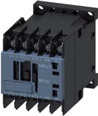
Leistungsschütz, AC-3e/AC-3, 9 A, 4 kW / 400 V, 3-polig, DC 24 V, Hilfskontakte: 1 S, Ringkabelschuhanschluss, Baugröße: S00
