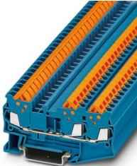
直通式接线端子，标称工作电压: 800 V，额定电流: 17.5 A，连接量: 3，接线方式: 快速连接，第一层，额定接线容量: 1.5 mm<sup>2</sup>，横截面: 0.25 mm<sup>2</sup> - 1.5 mm<sup>2</sup>，安装方式: NS 35/7.5，NS 35/7.5，颜色: 蓝色
