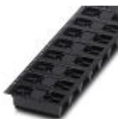
Embase de circuit imprimé, intensité nominale: 12 A, tension assignée (III/2): 320 V, nombre de pôles: 10, pas: 5,08 mm, coloris: noir, surface des contacts: étain, montage: Soudage THR, Des informations d'utilisation et des recommandations concernant la technologie THR sont disponibles dans la section Téléchargements.
