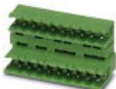
Embase de circuit imprimé, intensité nominale: 10 A, tension assignée (III/2): 320 V, nombre de pôles: 10, pas: 5,08 mm, coloris: vert, surface des contacts: étain, montage: Soudage à la vague, Juxtaposables ! Bride de fixation : Réf. 1736771, 1736768. En cas de combinaison d'éléments enfichables MVSTB ou FKCV, utiliser respectivement un connecteur mâle MVSTBW (ou FKCVW) et un MVSTBR (ou FKCVR). La combinaison avec des éléments enfichables TMSTBP est impossible !
