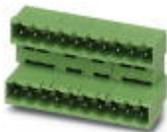
Embase de circuit imprimé, intensité nominale: 10 A, tension assignée (III/2): 320 V, nombre de pôles: 10, pas: 5,08 mm, coloris: vert, surface des contacts: étain, montage: Soudage à la vague, L'article est juxtaposable à différents nombres de pôles ! En cas de combinaison avec des éléments enfichables MVSTB ou FKCV, utiliser respectivement un connecteur mâle MVSTBW (ou FKCVW) et un MVSTBR (ou FKCVR). La combinaison avec des éléments enfichables TMSTBP est impossible !
