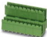
Embase de circuit imprimé, intensité nominale: 10 A, tension assignée (III/2): 320 V, nombre de pôles: 10, pas: 5,08 mm, coloris: vert, surface des contacts: étain, montage: Soudage à la vague, Juxtaposables ! Bride de fixation : Réf. 1836477, 1836480. En cas de combinaison d'éléments enfichables MVSTB ou FKCV, utiliser respectivement un connecteur mâle MVSTBW (ou FKCVW) et un MVSTBR (ou FKCVR). La combinaison avec des éléments enfichables TMSTBP est impossible !
