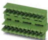
Embase de circuit imprimé, intensité nominale: 10 A, tension assignée (III/2): 320 V, nombre de pôles: 10, pas: 5,08 mm, coloris: vert, surface des contacts: étain, montage: Soudage à la vague, L'article est juxtaposable à différents nombres de pôles ! En cas de combinaison avec des éléments enfichables MVSTB ou FKCV, utiliser respectivement un connecteur mâle MVSTBW (ou FKCVW) et un MVSTBR (ou FKCVR). La combinaison avec des éléments enfichables TMSTBP est impossible !
