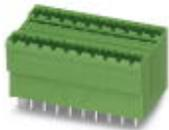
Embase de circuit imprimé, intensité nominale: 10 A, tension assignée (III/2): 320 V, nombre de pôles: 10, pas: 5,08 mm, coloris: vert, surface des contacts: étain, montage: Soudage à la vague, En cas de combinaison avec des éléments enfichables MVSTB ou FKCV, utiliser respectivement un connecteur mâle MVSTBW (ou FKCVW) et un MVSTBR (ou FKCVR). La combinaison avec des éléments enfichables TMSTBP est impossible !
