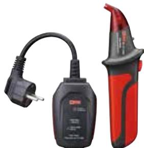
Dieser digitale RS PRO-Leistungsschalterfinder ist ideal zum schnellen Auffinden und Identifizieren von Leistungsschaltern oder Sicherungen an 110-V-50-Hz-Netzteilen. Das Gerät besteht aus einem an das Stromnetz angeschlossenen Sender und einem Empfänger mit LED-Anzeige und akustischem Signalalarm, wenn der richtige Leistungsschalter identifiziert wurde.
