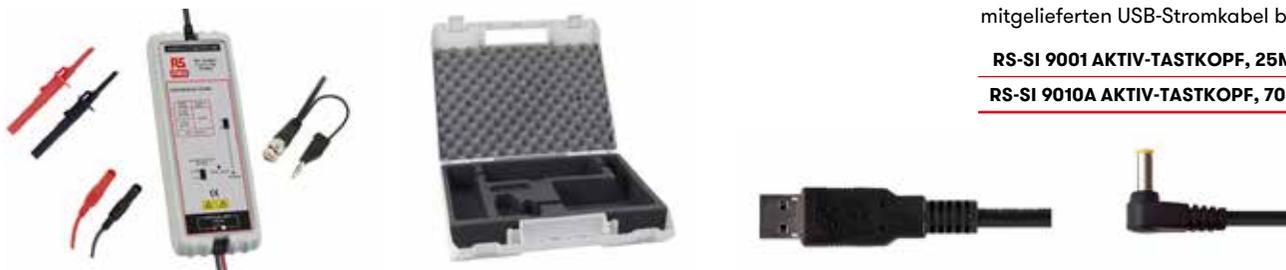
Der RS-SI 9001 ermöglicht sichere und genaue Messungen zwischen zwei aufeinander bezogenen Spannungssignalen und hat eine umschaltbare Dämpfung von 10: 1 und 100: 1, eine Bandbreite von 25 MHz und eine maximale Differenz von  $\pm 700$  V. Die Sonde kann entweder mit 4xAA-Batterien oder mit dem mitgelieferten USB-Stromkabel betrieben werden.
