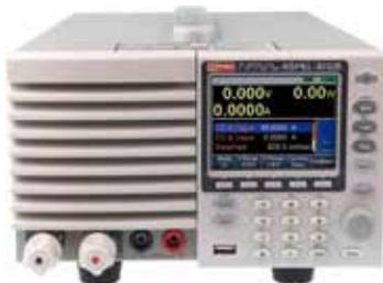
Der RSPEL-3032E bietet sieben Betriebsmodi und bietet Ihnen je nach gewünschter Anwendung eine Reihe von Optionen. Ein weiteres hervorragendes Merkmal ist die Soft-Start-Funktion, die nicht nur eine monotone Erhöhung der Ausgangsspannung ermöglicht, sondern auch das Auftreten von Einschaltstrom und Stoßspannung am Prüfling verhindert.
