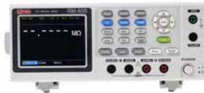
DC Milli-Ohm Messgeräte der Serie RM804 / 805 bieten RS-232C- und USB-Geräteschnittstellen (RM804, 122-5158) sowie Option 01 GPIB (RM804-01, 122-5157) oder Standard-GPIB (RM805, 122-5156).
