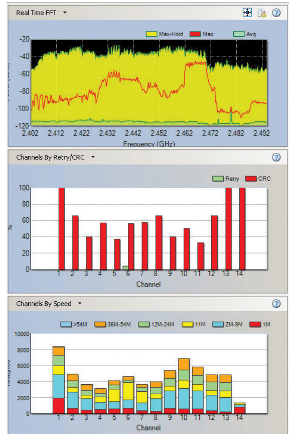
Abbildung 2: Analyse von HF-Störungen und Wi-Fi-Auswirkungen
