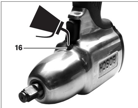
Après avoir effectué environ 100 000 vissages, graisser le mécanisme de frappe. Pour ce faire, tourner la visseuse à percussion jusqu'à ce que la poignée soit dirigée vers le haut. Dévisser la vis de fermeture **16** à
