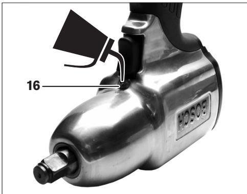
Na ca. 100 000 keer schroeven moet het slagmechanisme opnieuw gesmeerd worden. Draai daarvoor de slagmoeraanalyzer, zodat de handgreep omhoog wijst. Draai de sluitschroef **16** met een passende inbussleu-
