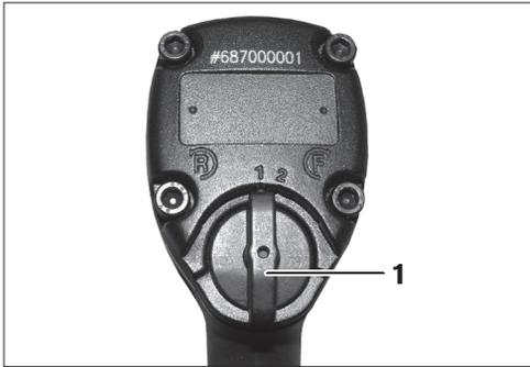
Suunnanvaihtokytkin **1** toimii sekä suunnanvaihtokytkimenä, että vääntömomentin säätimenä.
