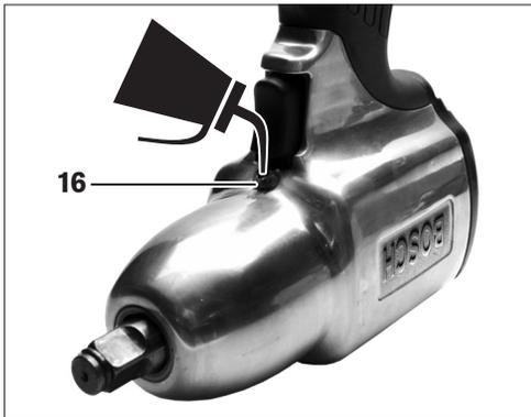
Cada 100 000 atornillados, aprox., es necesario relubricar el mecanismo percutor. Para ello, coloque la atornilladora de impacto de manera que la empuñadura
