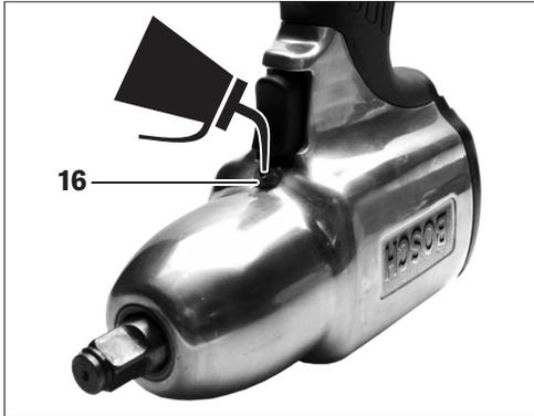
I intervaller om ca. 100 000 skruvdragningar måste slagverket smörjas på nytt. Vrid den slående skruvdragaren så att handtaget pekar uppåt. Skruva med en lämplig 6-kantnyckel moturs bort låsskruven **16** (se "Tekniska data", sida 83). Avfallshandera spilloljan på miljövänligt sätt. Fyll på motorolja i slagverket genom låsskruvens öppning. Oljemängden framgår av tabellen för motorolja (se "Tekniska data", sida 83). Torka bort överskottsolja med en mjuk trasa. Dra medurs fast låsskruven **16**.
