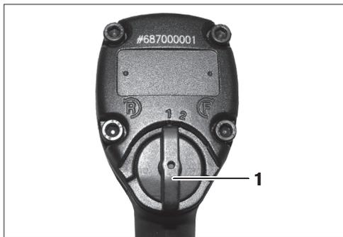
Der Drehrichtungsumschalter **1** dient sowohl zum Einstellen der Drehrichtung als auch zum Einstellen des Drehmoments.
