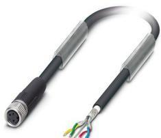
Câble préconfectionné pour bus, INTERBUS, 4-pôles, PUR exempt d'halogène, noir RAL 9005, blindé, extrémité libre, sur connecteur femelle droit M8, longueur de câble: 10 m
