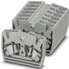
微型直通式接线端子，采用法兰和安全销固定安装端子，标称工作电压: 800 V，额定电流: 24 A，连接量: 2，接线方式: 回拉式弹簧连接，第一层，额定接线容量: 2.5 mm<sup>2</sup>，横截面: 0.08 mm<sup>2</sup> - 4 mm<sup>2</sup>，安装方式: 其他，颜色: 灰色
