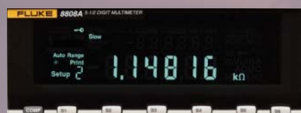
Configure la realización de seis medidas comunes mediante los botones del panel frontal y a continuación pulse la tecla adecuada para realizar cada una.
