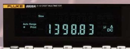
El 8808A puede medir pequeñas corrientes de fuga con una resolución de hasta 100 nA, sin cargar el circuito bajo comprobación.
