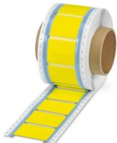
Schrumpfschlauch, Rolle, gelb, unbeschriftet, beschriftbar mit: THERMOMARK E.300 (D)/600 (D), THERMOMARK ROLLMASTER 300/600, THERMOMARK ROLL X1, THERMOMARK ROLL, THERMOMARK ROLL 2.0, THERMOMARK W, THERMOMARK X1.2, Kabeldurchmesserbereich: 8,5 ... 25,4 mm, unperforiert, Montageart: aufschieben, Anzahl der Einzelschilder: 250, Textfeldhöhe: 40 mm, Textfeldbreite: 60 mm
