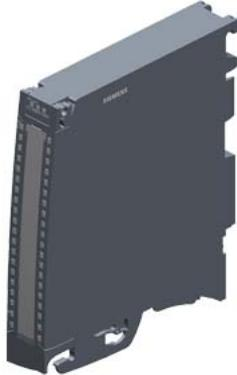
SIMATIC S7-1500, 模拟量输出模块 AQ 2x U/I ST, 16 位分辨率, 精度 0.3%. 2 条通道, 每组 2 条, 诊断; 替换值; 模块支持安全断开负载组至 SIL2 根据 ENIEC 62061:2021 和 Category 2 / PL c 根据 EN ISO 13849-1:2015。供货范围内包含直插式前连接器, 馈电元素, 屏蔽支架和屏蔽端子
