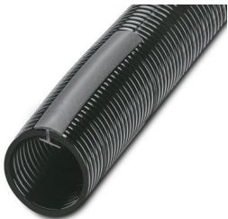
Schutzschlauch, Material: PA, UV-beständig: ja, flexibel, Schutzart: IP40, Farbe: schwarz, Brennbarkeitsklasse nach UL 94: HB, Innendurchmesser: 29 mm, Gesamtlänge: 10 m
