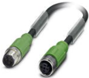
センサ/アクチュエータケーブル, 4極, PUR ハロゲンフリー, 黒-灰RAL 7021, シールド対応, プラグ ストレート M12, Aコーディング, 上 ソケット ストレート M12, Aコーディング, ケーブル長: 0.3 m
