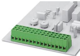
印制电路板终端，额定电流: 17.5 A，额定电压(III/2): 400 V，额定横截面: 1.5 mm<sup>2</sup>，电位数: 2，行数: 1，每行位数: 2，产品系列: KDSP 1,5，针距: 5 mm，接线方式: 带压片的螺钉连接，螺钉头规格: L 开槽，安装: 波峰焊，导线/PCB连接方向: 0°，颜色: 绿色，针脚排列: 直线排列，焊针[P]: 3.7 mm，每个电势的焊针数量: 2，包装类型: 纸箱包装。该产品可组成不同位数的连接器！
