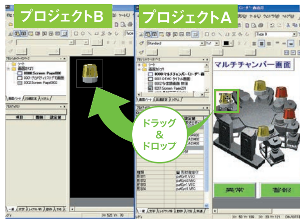
画面例2 取り込みたい部品を選択し、取り込み先にドラッグ&ドロップ。
