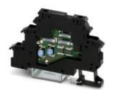
Reihenklemme mit dreistufigem Überspannungsschutz für zwei Signaladern mit gemeinsamem Bezugspotenzial, separater PE-Anschluss, Nennspannung: 24 V DC, Montage auf NS 35/7,5, Klemmenbreite: 6,2 mm, Klemmenhöhe: 54,6 mm
