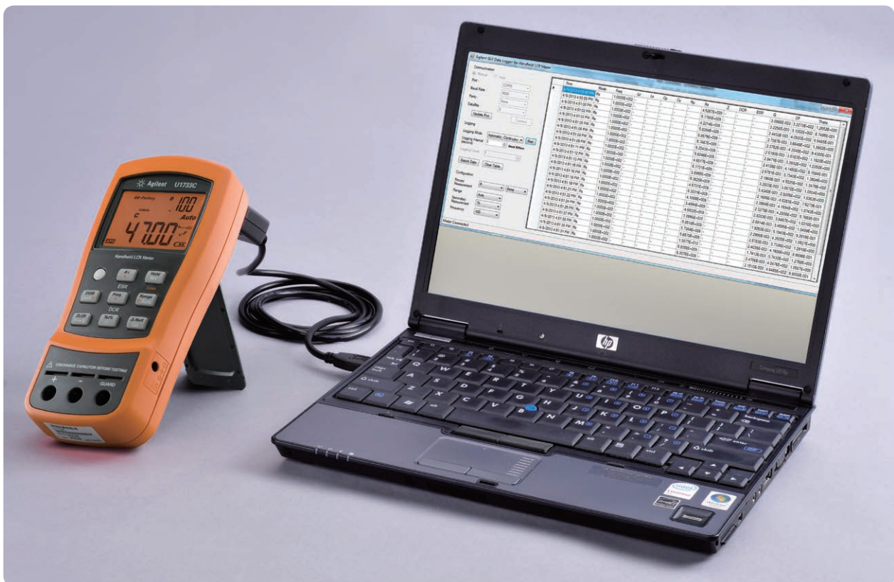
図1. U1731C/U1732C/U1733CをPCに接続すれば、連続した読み値の自動記録が可能
