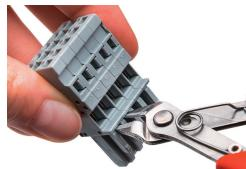
Codage d'un connecteur femelle – Enlever la(s) tige(s) de codage à l'aide d'un outil coupant Ni la 1ère ni la dernière tige de codage, elles servent à la fixation.
