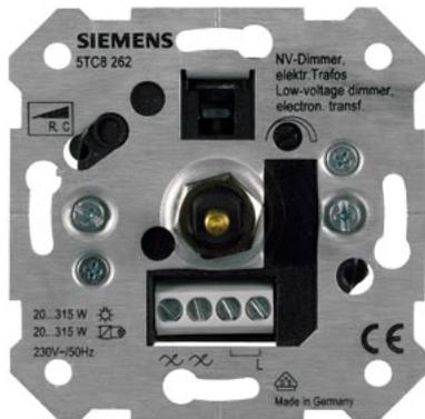
NV-Dimmer elektron. Trafos, R, C m. Druck-aus/Wechselschalter, UP 230V 50-60Hz, 20-315W Schraubklemmen für Krallen- und Schraubbefestigung
