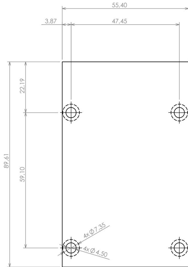
La ligne en pointillés indique le contour du bossage de montage sous la carte de circuit imprimé
