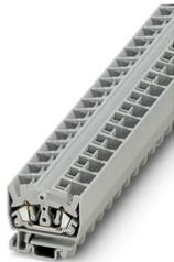
微型直通式接线端子，标称工作电压: 800 V，额定电流: 24 A，连接量: 4，接线方式: 回拉式弹簧连接，第一层，额定接线容量:  $2.5 \text{ mm}^2$ ，横截面:  $0.08 \text{ mm}^2 - 4 \text{ mm}^2$ ，安装方式: NS 15，颜色: 灰色
