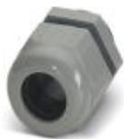
Presse-étoupe, matériau de presse-étoupe: PA, diamètre extérieur du câble 6 mm ... 12 mm, blindage: non, filetage de raccordement: M20 x 1,5, coloris: gris argent RAL 7001
