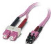
Câble FO équipé, câble Zipcord, fibre de verre multimode 50/125 µm, OM4, connecteurs : SC / LC, indice de protection : IP20, pour goulottes ou armoires électriques
