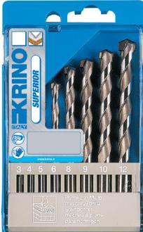
Corpo fresato con scanalatura ad "L" ad alta evacuazione. Placchetta M.D. resistente alla forte percussione, brasatura con lega saldante a 1100° C.
