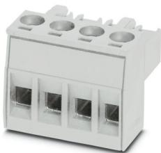
PCB插拔式连接器，额定横截面: 2.5 mm<sup>2</sup>，颜色: 浅灰，额定电流: 16 A (参见温度负荷曲线)，额定电压(III/2): 320 V，触点表面: Sn，触点类型: 孔式插头，电位数: 4，行数: 1，位数: 4，连接量: 4，产品系列: MSTBT 2,5 HC/..-STP，针距: 5 mm，接线方式: 带压片的螺钉连接，导线/PCB连接方向: 0°，锁扣: -锁扣，插拔系统: COMBICON MSTB 2,5 HC，互锁: 不带，安装方式: 不带，包装类型: 纸箱包装
