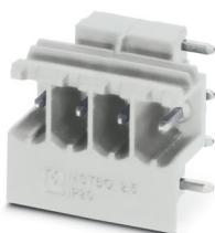
PCB插座，额定横截面: 2.5 mm<sup>2</sup>，颜色: 浅灰，额定电流: 16 A，额定电压 (III/2): 320 V，触点表面: Sn，触点类型: 针式插头，行数: 1，位数: 4，产品系列: MSTBO 2,5/..-G1PR，针距: 5 mm，安装: 波峰焊，针脚排列: 直线排列，焊针[P]: 3.5 mm，每个电势的焊针数量: 1，插拔系统: COMBICON MSTB 2,5，针式连接器样式对齐: 垂直，互锁: 不带，包装类型: 纸箱包装，产品右侧带有针式插头输出
