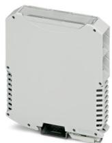
DIN导轨壳体，带金属脚扣的全套壳体，高型设计，带通风栅，宽度: 22.6 mm，高度: 99 mm，深度: 113.65 mm，颜色: 浅灰 (类似 RAL 7035)，交叉连接: DIN导轨总线连接器 (可选)，横向连接器的位置编号: 5
