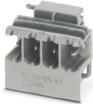
PCB插座，额定横截面: 2.5 mm<sup>2</sup>，颜色: 浅灰，额定电流: 16 A，额定电压(III/2): 320 V，触点表面: Sn，触点类型: 针式插头，电位数: 4，行数: 1，位数: 4，连接量: 4，产品系列: MSTBO 2,5/..-G1PL，针距: 5 mm，安装: 波峰焊，针脚排列: 直线排列，焊针[P]: 3.5 mm，每个电势的焊针数量: 1，插拔系统: COMBICON MSTB 2,5，针式连接器样式对齐: 垂直，互锁: 不带，包装类型: 纸箱包装，产品左侧带有针式插头输出
