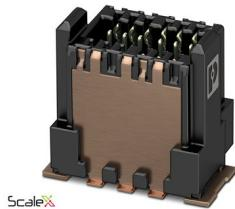
シールド対応のSMDオスコネクタ、定格電流: 1.7 A、耐電圧: 500 V AC、極数: 32、ピッチ: 0.8 mm、色: 黒、コンタクト表面: 金、コンタクトタイプ: ピン、取付け方法: SMDハンダ接続
