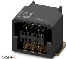
シールド対応のSMDメスコネクタ、定格電流: 1.7 A、耐電圧: 500 V AC、極数: 32、ピッチ: 0.8 mm、色: 黒、コンタクト表面: 金、コンタクトタイプ: メス、取付け方法: SMDハンダ接続
